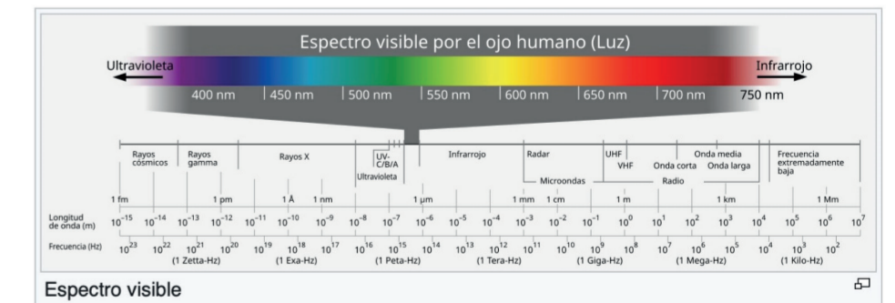
FIGURA 5. ESPECTRO electromagnético. Se resalta en gris la región del espectro visible para los humanos. Figura original de Horst Frank, tomada de https://es.wikipedia.org/wiki/Espectro_visible
