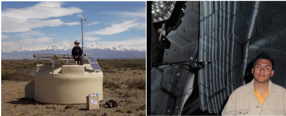
FIGURA 2. SUPERIOR, el observatorio HAWC, donde cada tanque puede almacenar aproximadamente 200,000 litros de agua purificada. Estos tanques tienen un diámetro de 7.3 metros y una altura de 4.5 metros (Crédito de la imagen J. Goodman, Nov. 2016) [3]. Abajo izquierda, uno de los detectores de superficie del Observatorio Pierre Auger. Estos tanques cilíndricos están equipados con paneles solares, antenas y sistemas de registro autónomos para detectar las partículas secundarias que llegan a nivel del suelo tras la colisión de rayos cósmicos de ultra alta energía con la atmósfera. Al fondo se observa la cordillera de los Andes. Imagen obtenida de: https://www.astronomie.nl/instrument/pierre-auger-cosmic-ray-observatory-23. Abajo Derecha, detectores de fluorescencia que registran el paso de la cascada de partículas secundarias a través de la atmósfera. Imagen cortesía del M. Sc. Pedro Alfonso Valencia Esquipula.
