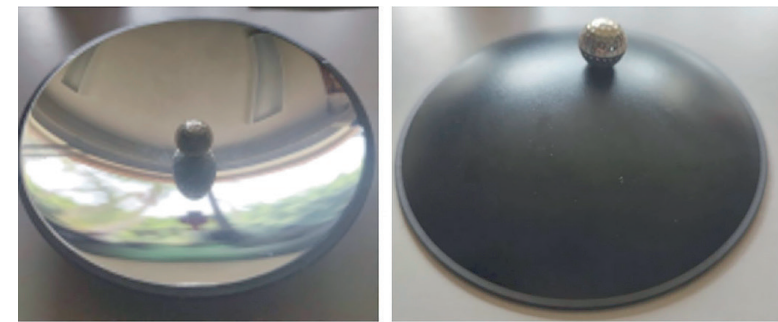
FIGURA 4. UNA canica que rueda en el interior de un plato semiesférico llega a un punto de equilibrio estable en el centro (izquierda), mientras que si rueda en el exterior del mismo plato se aleja aceleradamente del ahora inestable centro (derecha).
