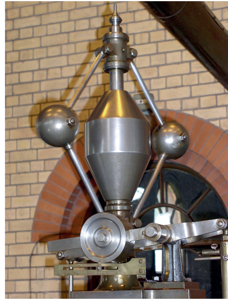
FIGURA 2. GOBERNADOR formado por un par de esferas que giran pudiendo alejarse o acercarse al eje y que controlan una máquina bajando su velocidad a través de una válvula que se cierra cuando las esferas se alejan del eje debido a una velocidad y fuerza centrífuga excesiva. Imagen tomada de https://upload.wikimedia.org/wikipedia/commons/3/38/Ashton_Frost_engine_governor.jpg (Globbet, CC BY-SA 3.0 https://creativecommons.org/licenses/by-sa/3.0 , via Wikimedia Commons).
