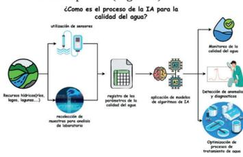
**FIGURA 2. PROCESO** de la IA para la calidad del agua. El diagrama ilustra cómo la inteligencia artificial se aplica en el monitoreo y tratamiento del agua. A través de sensores y análisis de laboratorio, se registran los parámetros de calidad, que luego son procesados por modelos de IA para detectar anomalías, diagnosticar problemas y optimizar los procesos de tratamiento del agua. Fuente: elaboración propia.
