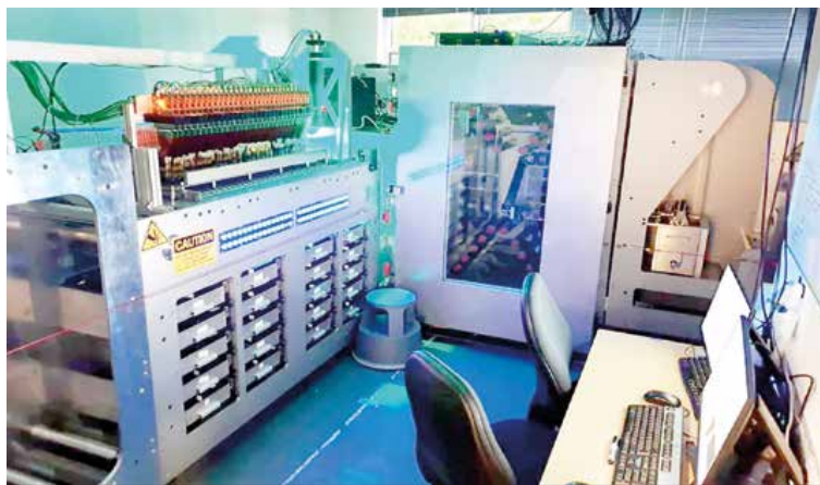
FIGURA 5. "MÁQUINA de escribir" de ADN de la empresa CATALOG. Puede escribir hasta 4 Megabits por segundo. Tomada de https://www.cnet.com/news/startup-packs-all-16gb-wikipedia-onto-dna-strands-demonstrate-new-storage-tech/
