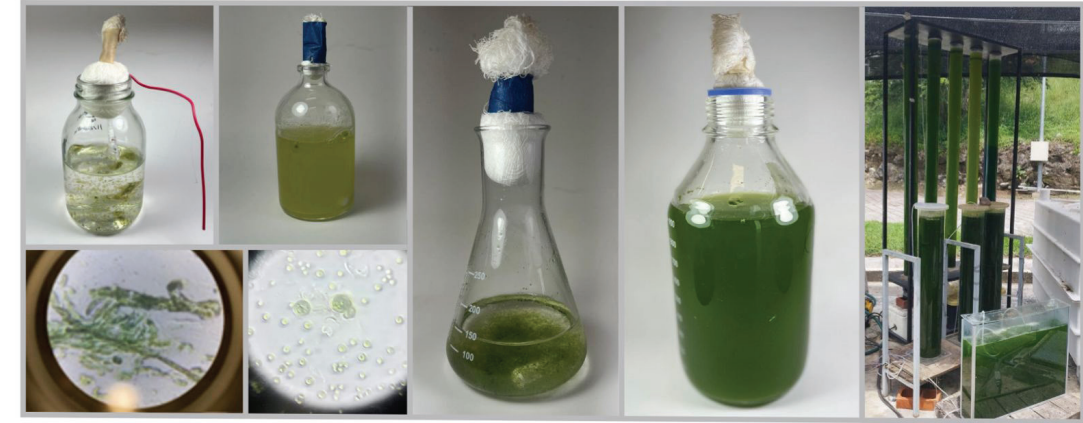
FIGURA 2. DESDE un frasco casero hasta un fotobiorreactor: las microalgas pueden cultivarse en recipientes simples para uso educativo o en sistemas controlados como los del Instituto de Energías Renovables de la UNAM.
