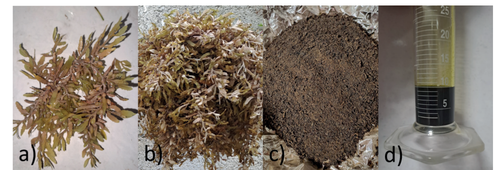
FIGURA 4. A) Sargazo recolectado en Yucatán, b) sargazo secado al sol por 48 horas, c) sargazo en polvo y d) extracto de sargazo.
