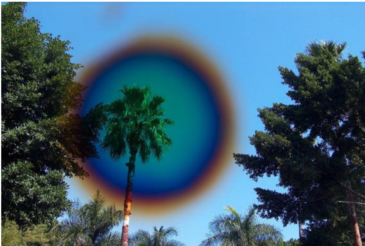
Dentro del círculo está la foto tomada con un filtro de silicio poroso. Observa que la imagen es ahí más nítida (Foto:CIE-UNAM).
