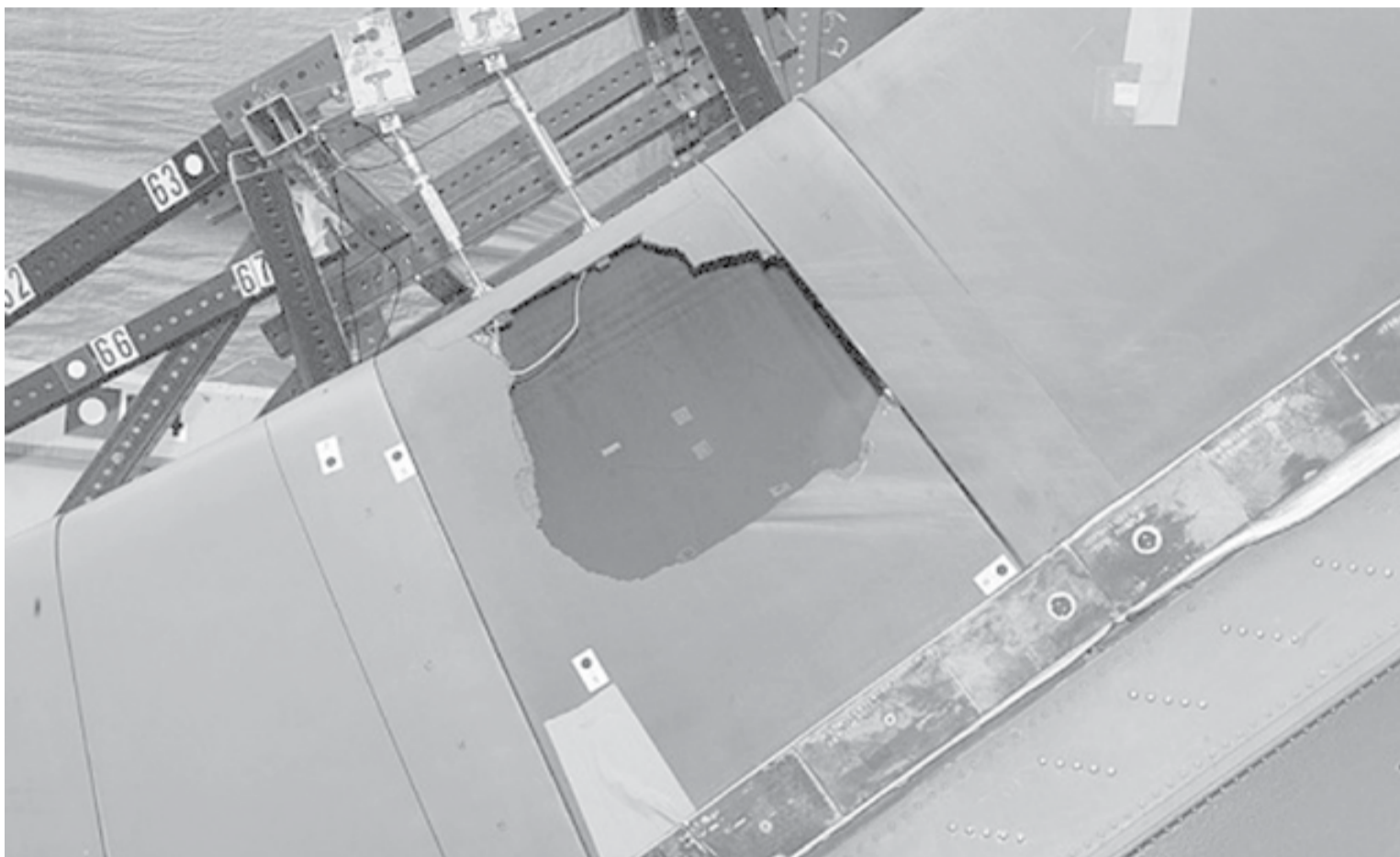
1. Orificio causado en el ala del transbordador espacial Endeavor. La fractura fue causada en la misión espacial STS-118, cuando un hule espuma desprendido por un tanque propulsor externo fue liberado durante el despegue.
