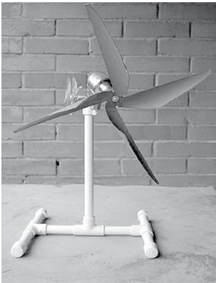
Figura 6. Prototipo de aerogenerador casero diseñado por el Dr. Antonio del Río del IER-UNAM
