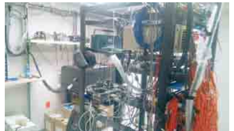
4. Fibras ópticas (cables anaranjados) que llevan pulsos luminosos producidos por un láser (al fondo en el centro) para calibrar el sistema de fotodetectores, los cuales envían señales optoelectrónicas al cuarto de control cada vez que captan fotones Cherenkov en los tanques de agua.
