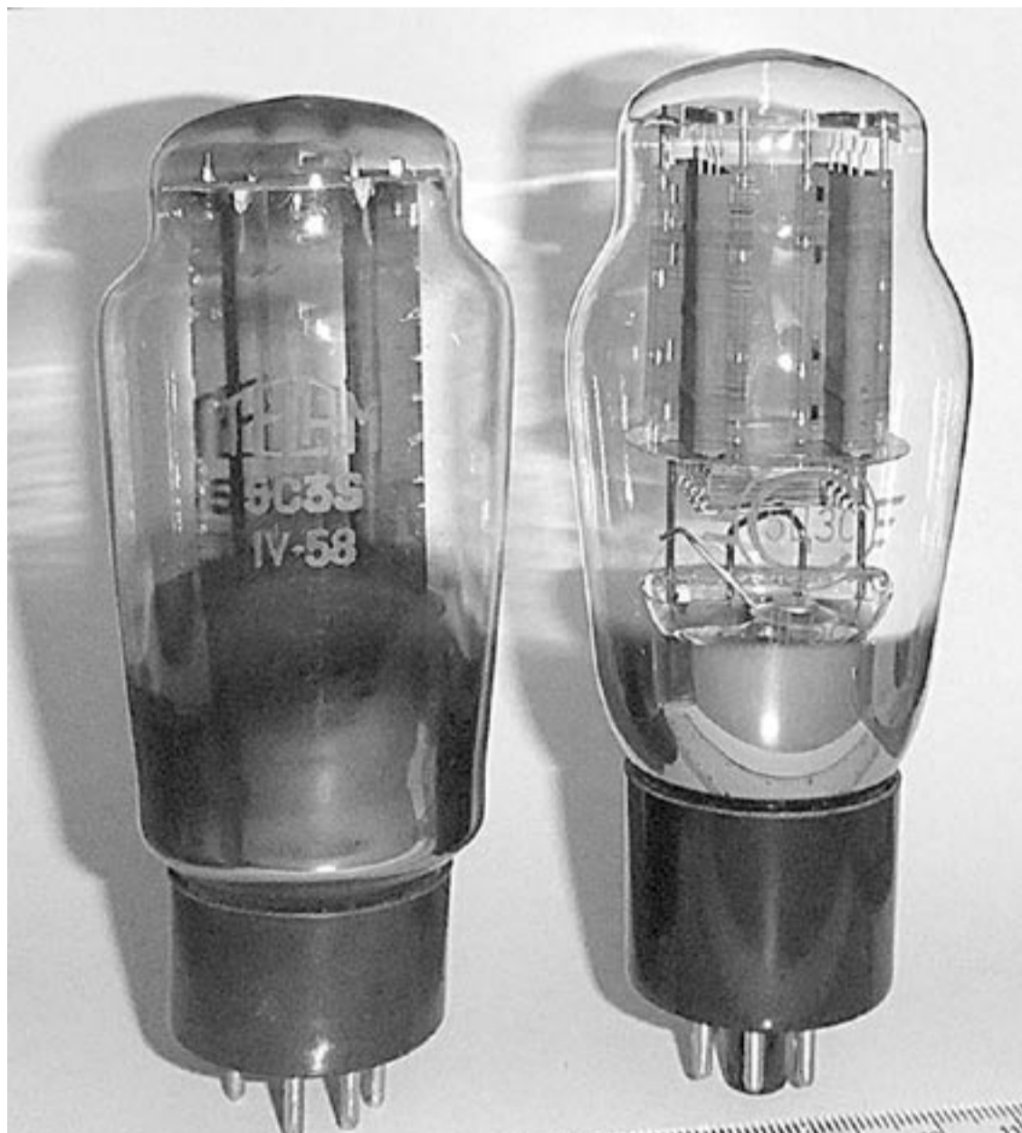
Figura 1. Los bulbos o válvulas de vacío son los dispositivos característicos de la electrónica de mediados del siglo pasado. En la parte inferior de la figura se puede apreciar una escala que da una idea del tamaño típico que tenían.
