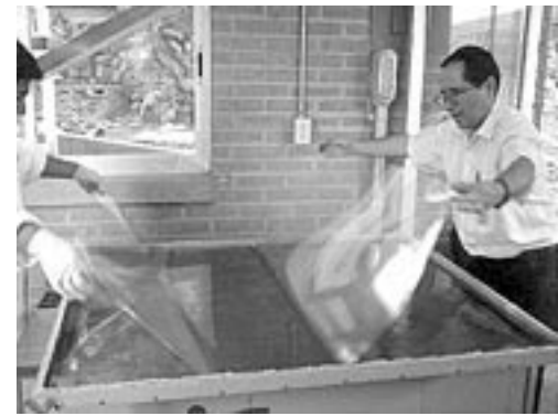
Figura 4. Laboratorio de elaboración de películas delgadas semiconductoras por depósito químico en el Centro de Investigación en Energía de la UNAM.
